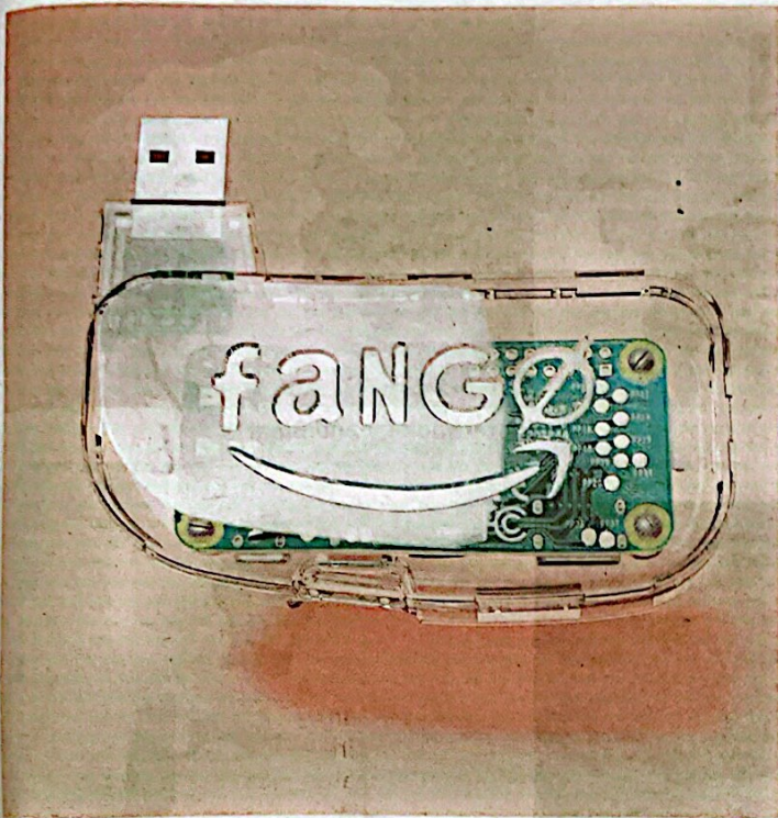
FANGØ (Martin Nadal, ES): Angesteckt an ein Smartphone simuliert der Mikro-Controller willkürliche Suchanfragen, Likes und Postings auf sozialen Medien und verhindert so, dass online persönliche Daten gesammelt werden.
